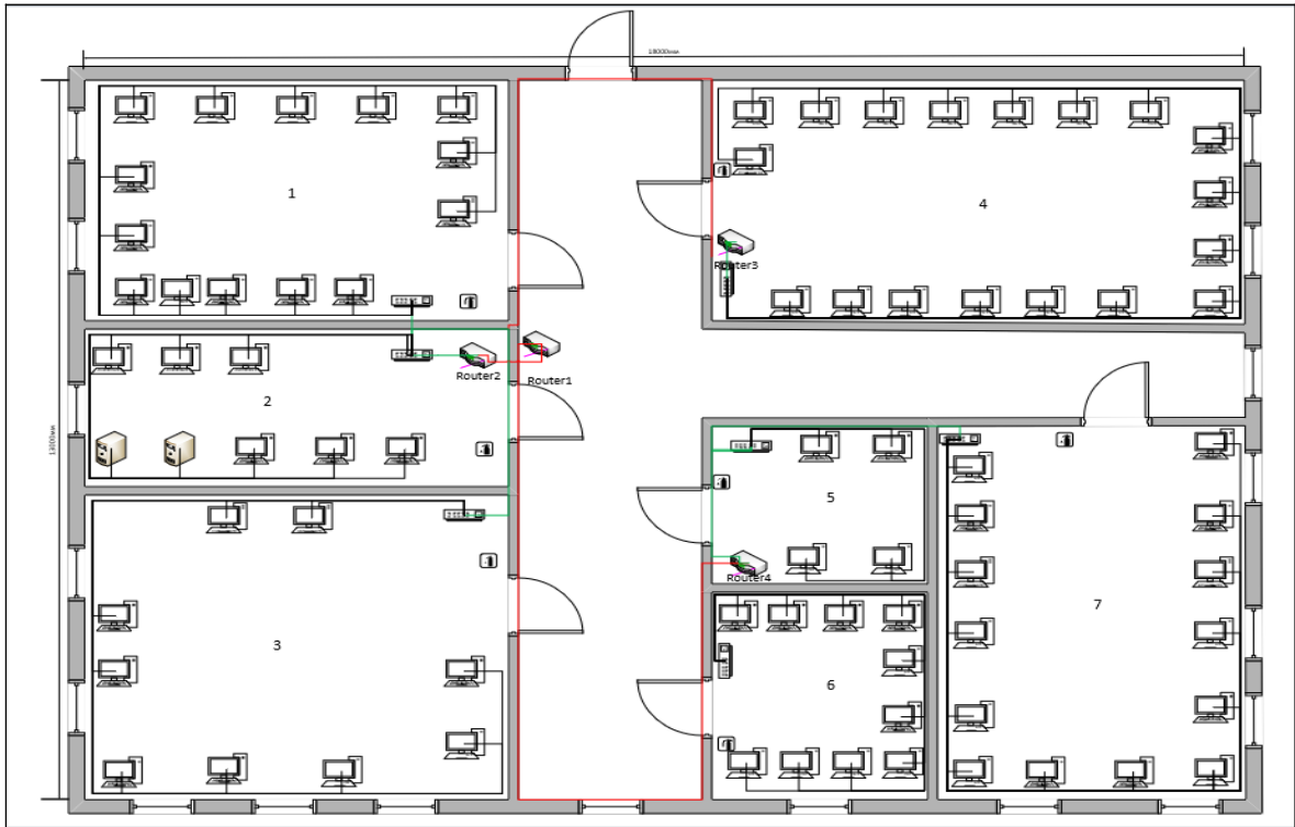
Рис. 3.11 – Монтажна схема комп'ютерної мережі ПАТ «ЗФЗ»
