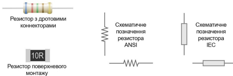
Рисунок 2.6 – Вигляд та схематичне зображення резисторів
